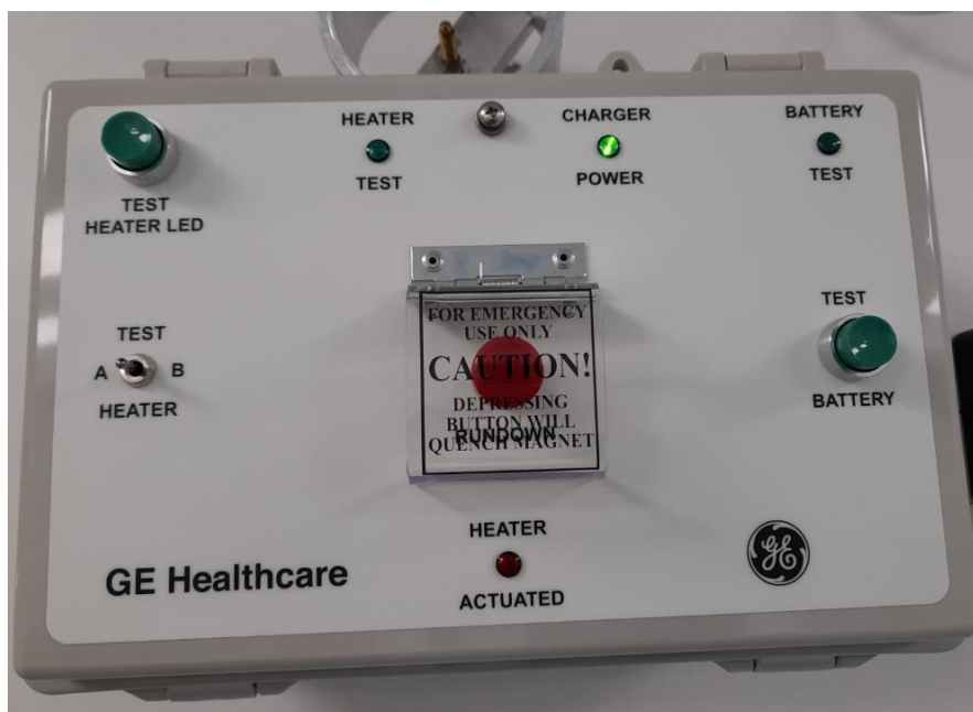
Fig. 6: Apparato per i controlli del corretto funzionamento del sistema di quench
