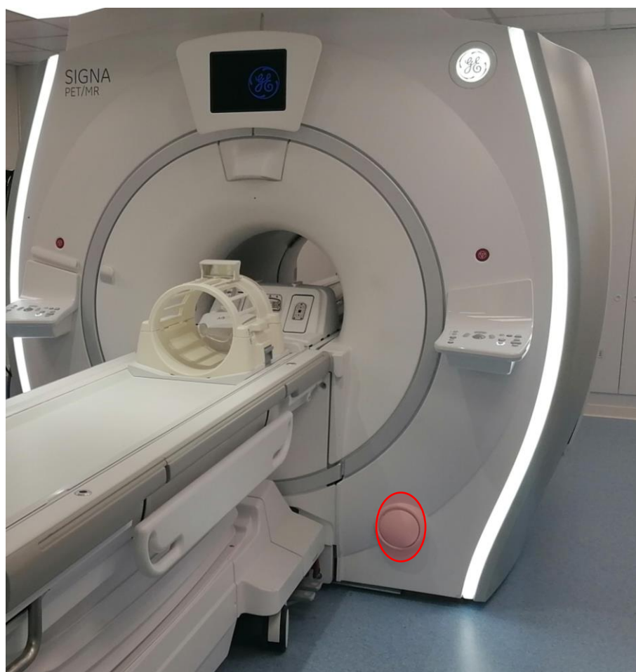
Fig. 4: Accesso attivazione del quench con sistema secondario
